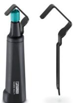
**Pelacables**, para desgarrar cables de 4,5 mm - 40 mm Ø, grosor de aislamiento hasta 4,5 mm, cuchilla orientable para cortes circulares, longitudinales y en espiral
