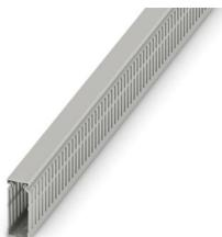
Canal de cableado para la instalación y el montaje en armarios de control, gris, formado por parte superior e inferior, ancho: 25 mm, altura: 60 mm, longitud: 2000 mm
